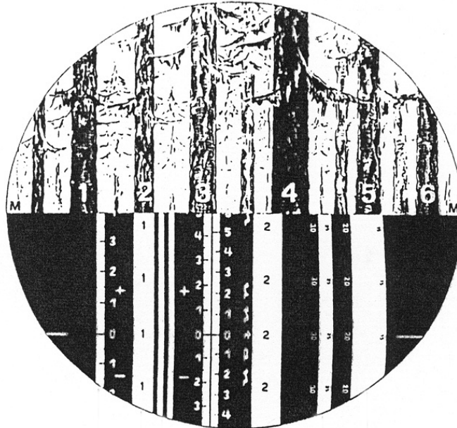
Figura 88. Vista geral dentro do Relascópio de Espelho; a linha de leitura ou pontaria separa os dois semicírculos.
