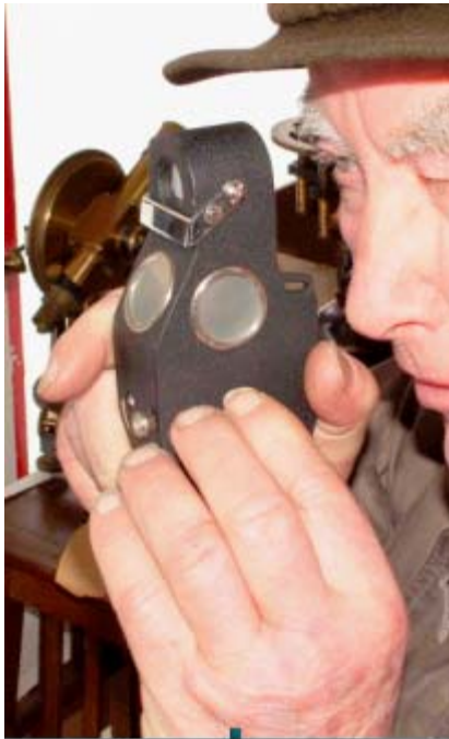
Figura 86. Posição correta de se manusear o Relascópio de Espelho.
